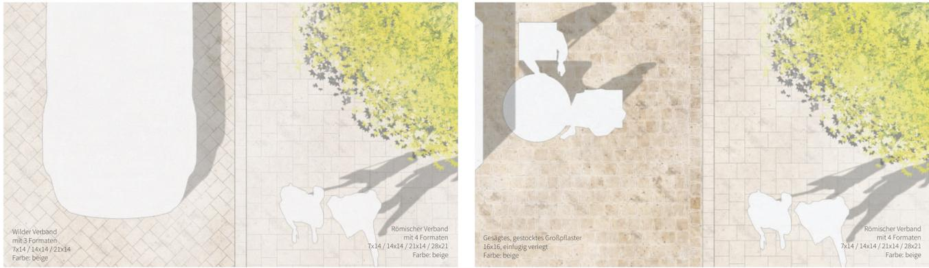
Detail Pflastermuster Übergang Fahrbahn zu Gehweg M 1:20
